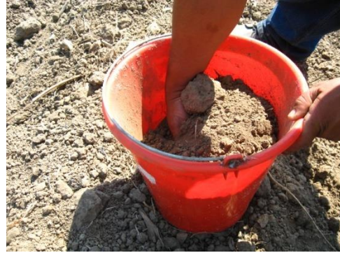
Figura 5. Mezcla homogénea de las submuestras de suelos y toma de una muestra compuesta
