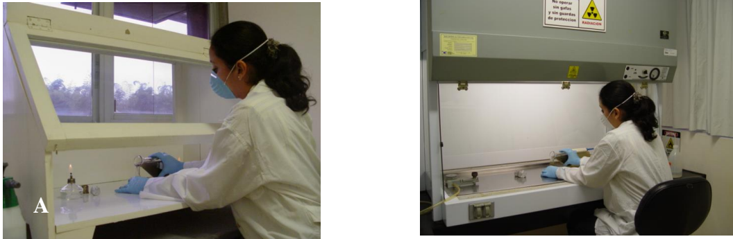
Figura 6. Cámara de aislamientos (A) y cámara de flujo laminar (B) utilizadas en los procesos de aislamiento e inoculación de hongos entomopatógenos.
