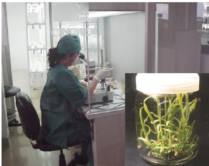
Figura 3. Cámara de extracción de meristemos y frasco con plantitas en medio de multiplicación
